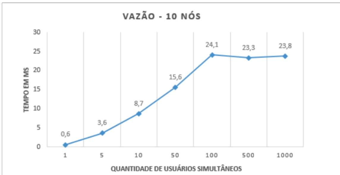
Figure 5.2: Vazão da Blockchain com 10 nós para diferentes cargas de trabalho.
